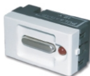
Descripción Pulsador Manual Tipo Digital 220 V 6A Infrarrojo Pasivo p/encendido Aut. de Luz (p/todo tipo de lámp.) Max. 1500W Artículo 10274/2 10272/2
