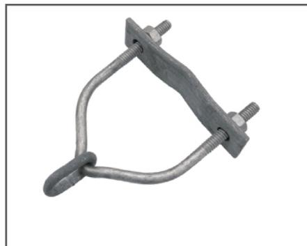
Abrazadera para pilar domiciliario, para caños de pilar con un Ø máximo 48mm, diseñada con una planchuela de base lisa para no dañar el recubrimiento epoxi de los caños.
