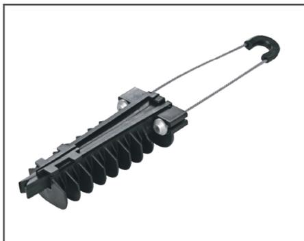
La morsa de retención PRA-1500 está diseñada para la retención de conductores preensamblados de baja tensión y redes compactas MT. Soporta esfuerzos de hasta 1800kg. Cumple con todas las exigencias de las normas nacionales e internacionales. Permite sujetar conductores de 50 a 70 mm<sup>2</sup>. Fabricada en Nylon 6/6, con cables de acero de gran resistencia, el uso de esta morsa garantiza la más sólida y confiable fijación.
